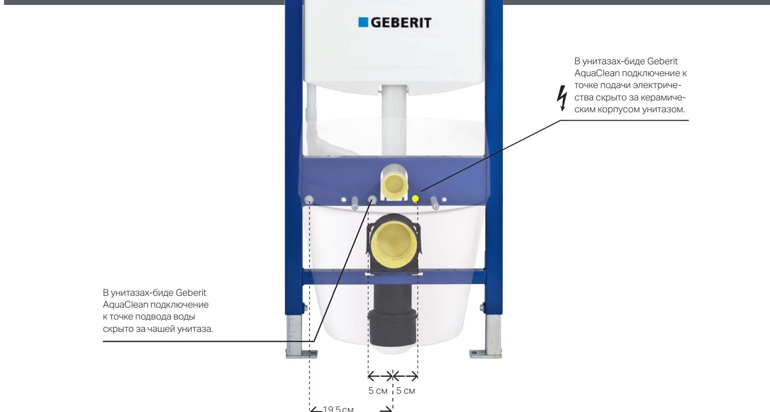
Инсталляции Geberit применяются как при строительстве новых объектов, так и при реконструкции ранее построенных. В каждой инсталляции предусмотрены точки подключения воды и электричества, благодаря этому установка любого унитаза-биде не представляет затруднений. Для уже установленных унитазов, не имеющих необходимых соединительных элементов для подключения к точке подвода воды и подачи электричества, Geberit предлагает различные комплекты для их подключения.
