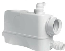
Genix WL соединен со сливом унитаза, разработан для установки с подвесной техникой или там, где места за туалетом недостаточно для установки стандартного Genix. Имеет встроенный измельчитель и эффективно работает с остатками в воде (включая фекальный материал).
