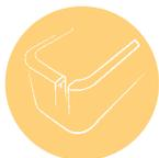
**METAL RIM – МЕТАЛЛИЧЕСКИЙ ПРОФИЛЬ, ВСТРОЕННЫЙ В АКРИЛОВЫЕ КРОМКИ ВАНН. БЛАГОДАРЯ НАЛИЧИЮ ТАКОГО ПРОФИЛЯ ВАННА СТАНОВИТСЯ БОЛЕЕ УСТОЙЧИВОЙ. ВО ВРЕМЯ ТРАНСПОРТИРОВКИ, МОНТАЖА И ЭКСПЛУАТАЦИИ ЕЙ НЕ ГРОЗИТ ИСКАЖЕНИЕ.**
