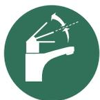
ТЕХНОЛОГИЯ ВОДОСБЕРЕЖЕНИЯ ПОМОЖЕТ ВАМ РЕГУЛИРОВАТЬ НЕОБХОДИМОЕ КОЛИЧЕСТВО ПОТРЕБЛЯЕМОЙ ВОДЫ. ОПТИМАЛЬНОЕ (РЕГУЛИРУЕТСЯ АВТОМАТИЧЕСКИ) ПОЛОЖЕНИЕ РЫЧАГА СМЕСИТЕЛЯ ДАЁТ ДОСТАТОЧНЫЙ ПОТОК ВОДЫ ДЛЯ МЫТЬЯ ПОСУДЫ И РУК. ПОДНИМИТЕ РЫЧАГ В САМОЕ ВЕРХНЕЕ ПОЛОЖЕНИЕ ДЛЯ МАКСИМАЛЬНОГО ПОТОКА ВОДЫ И ОТПУСТИТЕ РЫЧАГ, ЧТОБЫ ОН ВЕРНУЛСЯ АВТОМАТИЧЕСКИ В ПЕРВОНАЧАЛЬНОЕ ПОЛОЖЕНИЕ. КОМФОРТНЫЙ ПОТОК ВЫ МОЖЕТЕ НАСТРОИТЬ ИНДИВИДУАЛЬНО В СООТВЕТСТВИИ С ВАШИМИ ПОТРЕБНОСТЯМИ.
