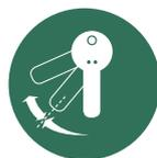
ЭНЕРГОСБЕРЕГАЮЩАЯ ФУНКЦИЯ НАШИХ СМЕСИТЕЛЕЙ ПОЗВОЛЯЕТ СНИЗИТЬ ПОТРЕБЛЕНИЕ ГОРЯЧЕЙ ВОДЫ (ЭНЕРГИИ) НА 50%. РЕШЕНИЕ ПРОСТОЕ И ОРИГИНАЛЬНОЕ. ДЛЯ МАКСИМАЛЬНОЙ ТЕМПЕРАТУРЫ РУКОЯТКУ РЫЧАГА СЛЕДУЕТ ПОВЕРНУТЬ В КРАЙНЕЕ ЛЕВОЕ ПОЛОЖЕНИЕ. ЕСЛИ РЫЧАГ ОТПУСТИТЬ, ОН АВТОМАТИЧЕСКИ ВЕРНЁТСЯ В ПОЛОЖЕНИЕ КОМФОРТНОЙ ТЕМПЕРАТУРЫ. ТАКИМ ОБРАЗОМ, СМЕСИТЕЛЬ ЭКОНОМИТ ЭНЕРГИЮ И ВАШИ ДЕНЬГИ. КОМФОРТНУЮ ТЕМПЕРАТУРУ ВЫ МОЖЕТЕ НАСТРОИТЬ ИНДИВИДУАЛЬНО В СООТВЕТСТВИИ С ВАШИМИ ПОТРЕБНОСТЯМИ.
