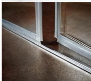
ДУШЕВЫЕ КАБИНЫ, НЕ ИМЕЮЩИЕ НАПОЛЬНОГО ПРОФИЛЯ, ТРЕБУЮТ НАЛИЧИЯ ГЛАДКОГО ПОЛА С ЛЕГКИМ НАКЛОНОМ В СТОРОНУ СЛИВНОГО ОТВЕРСТИЯ В ПОЛУ. ДЛЯ ЗАЩИТЫ ОТ ПРОТЕКАНИЯ ВОДЫ ПО ПОЛУ ЗА ПРЕДЕЛЫ КАБИНЫ В КОМПЛЕКТ ВХОДИТ ПОРОГ, КОТОРЫЙ КРЕПИТСЯ С ПОМОЩЬЮ КЛЕЯ ИЛИ СИЛИКОНА К ПОЛУ ВАННОЙ КОМНАТЫ. БЛЕСТЯЩИЙ ПРОФИЛЬ ИЗ АНОДИРОВАННОГО АЛЮМИНИЯ В СОЧЕТАНИИ С БОЛЬШОЙ СТЕКЛЯННОЙ ПАНЕЛЬЮ СОЗДАЕТ ЭФФЕКТ ЭКСКЛЮЗИВНОСТИ.
