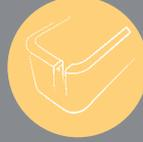
METAL RIM – МЕТАЛЛИЧЕСКИЙ ПРОФИЛЬ, ВСТРОЕННЫЙ В АКРИЛОВЫЕ КРОМКИ ВАНН. БЛАГОДАря НАЛИЧИЮ ТАКОГО ПРОФИЛЯ ВАННА СТАНОВИТСЯ БОЛЕЕ УСТОЙЧИВОЙ. ВО ВРЕМЯ ТРАНСПОРТИРОВКИ И МОНТАЖА ЕЙ НЕ ГРОЗИТ ДЕФОРМАЦИЯ.
