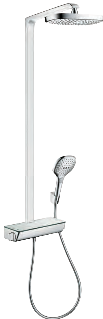
Raindance® Select E 300 2jet Showerpipe с верхним душем Raindance Select E 300 2jet (17 л/мин), ручным душем Raindance Select E 120 3jet (16 л/мин) и термостатом Ecostat Select, вынос душа 380 мм # 27128, -000, -400
