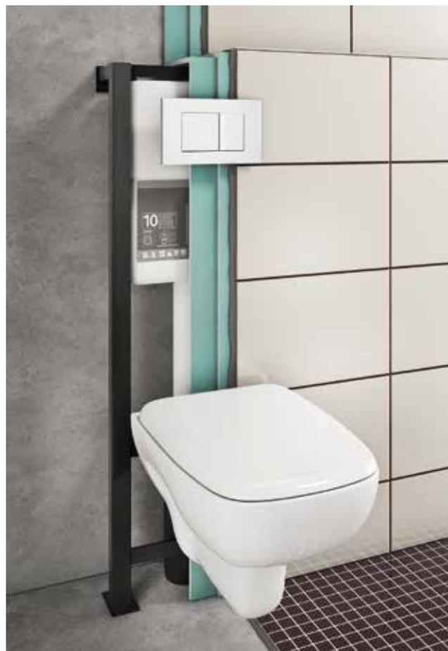
В стене скрыт монтажный стенд, на который и крепится подвесной унитаз или биде. Пространство, конечно, должно быть защищено от попадания воды и образования конденсата. Не забудьте предусмотреть отверстие для смотрового люка, который необходим для технического обслуживания или ремонта. В качестве люка может выступать панель кнопки смыва, также можно сделать съемную панель в стене.
