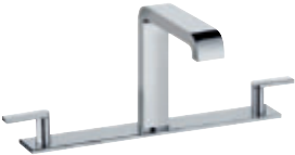
Смеситель для умывальника на 3 отверстия исполнение с панелью штихмас 200 мм с/без гарнитура для слива и донного клапана штихмас 300 мм с гарнитуром для слива и с донным клапаном, монтаж на три отверстия, 90° краны-буксы с керамическими уплотнительными шайбами
