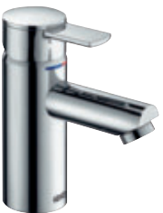
Однорычажный смеситель для умывальника с/без гарнитура для слива и донного клапана, для открытых водонагревателей, монтаж на одно отверстие, керамический картридж с ограничением температуры
