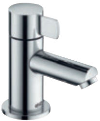
Смеситель на 1 подводку с/без гарнитура для слива и донного клапана, монтаж на одно отверстие, 90° кран-букса с керамическими уплотнительными шайбами
