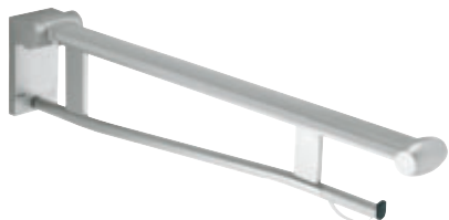
Поручень откидной для туалета* откидывается вверх, с плавным опусканием, опорная поверхность из пластика, со съемным держателем туалетной бумаги (со стопором) вылет 700/850 мм
