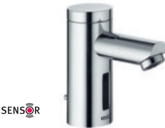
Сенсорный смеситель для умывальника Basic/Komfort с/без гарнитура для слива и донного клапана, монтаж на одно отверстие, модульный моноблок без тумбы, инфракрасная сенсорика (автоматическая настройка), продолжительность действия регулируется, быстрое действие регулируется (литиевая батарейка 6 В DL 223 А)
