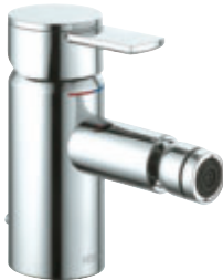
Однорычажный смеситель для биде с гарнитурой для слива и донным клапаном, монтаж на одно отверстие керамический картридж с ограничением температуры
