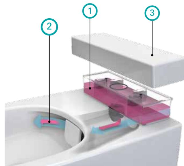
1 Емкость для жидкого моющего средства, расположенная в верхней части конструкции унитаза, смешивает дезинфицирующее средство\* с водой при смыве для максимальной гигиеничности.
